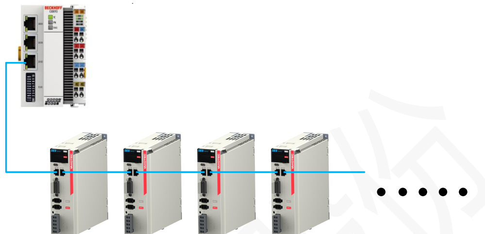
图 5.1 EtherCAT 主从网络构成
