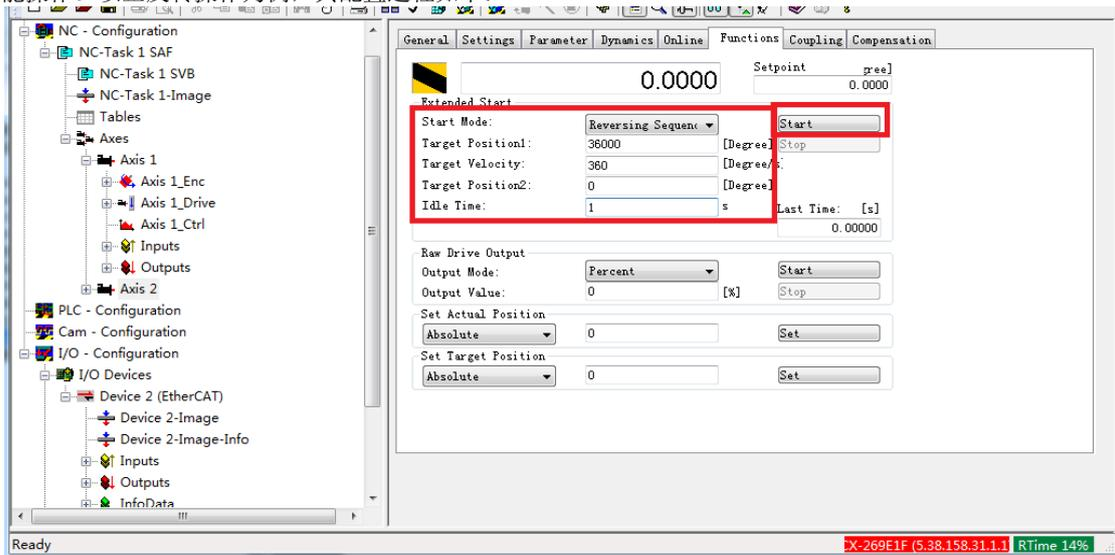
设定好运行模式（Reversing Sequence），正反转的端点位置，目标速度以及空闲等待时间后，按 Start 按钮，伺服轴将在正反转行程内连续做循环往复运动。
