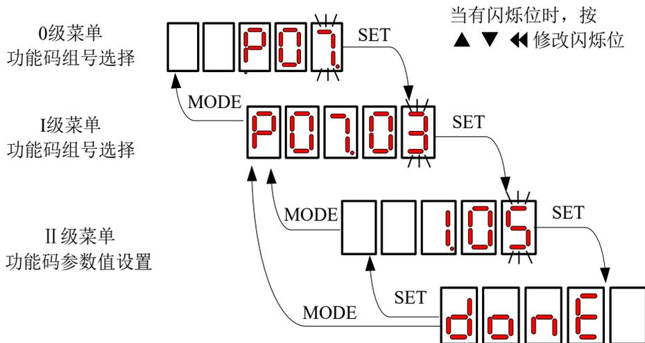
图 4-4 操作面板使用示意图
