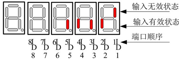
图7-8. P18-23对应的DO 端子电平显示
