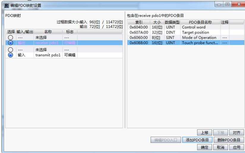
根据运动控制实际情况配置 PDO 映射列表。通过添加 PDO 条目或删除 PDO 条目修改 PDO 映射对象，常用的基本映射参数如下：
