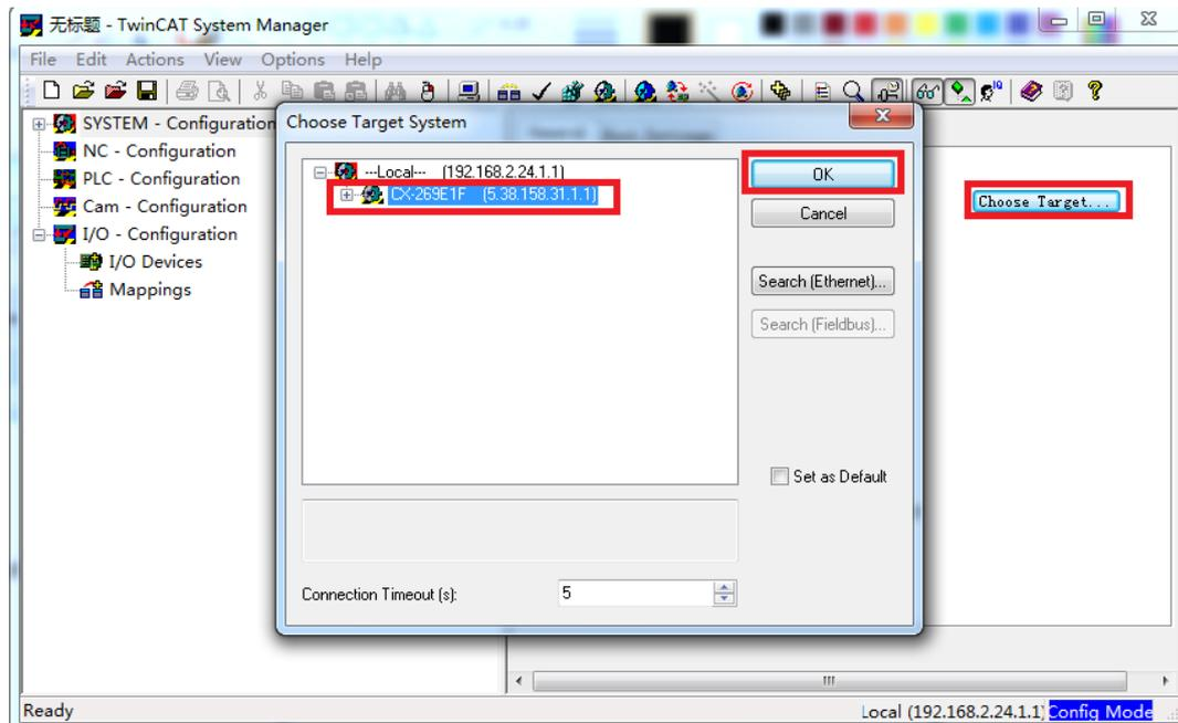
6, 请确认已经连接到 cx9020 目标系统
