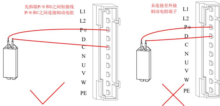
图5-10 AS3-08BNI、AS3-10BNI机型外接制动电阻连接示意图
