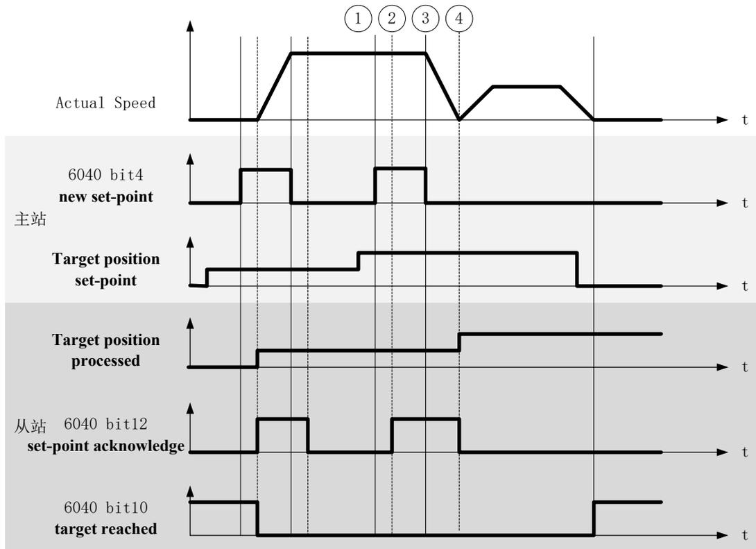
6040h(Control word)的bit5(change set immediately)是0时，如果已经将动作中定位动作数据变更，现在的定位动作完成后，开始下一定位动作。
