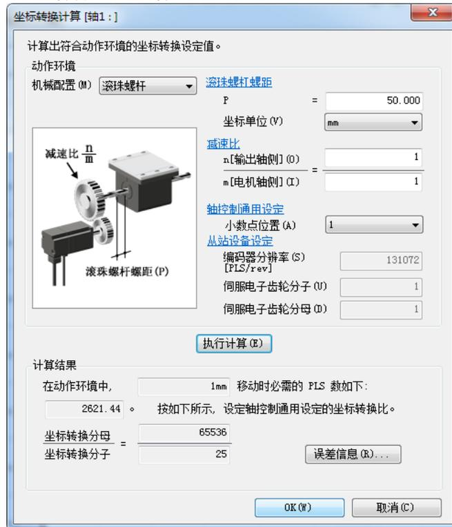
注：每次修改电机分辨率后，需要重新进行坐标转换。
