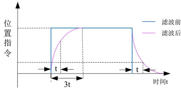
图6-7 位置指令平滑滤波器示意图
