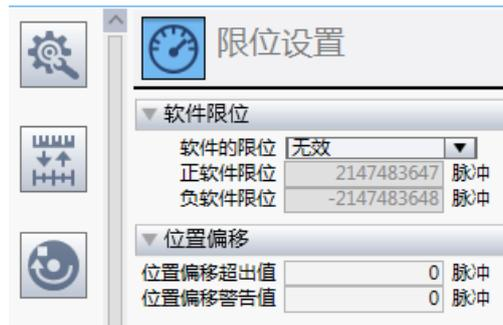
可选用软件限位功能，使用上位机进行原点回零后，软件限位生效；
