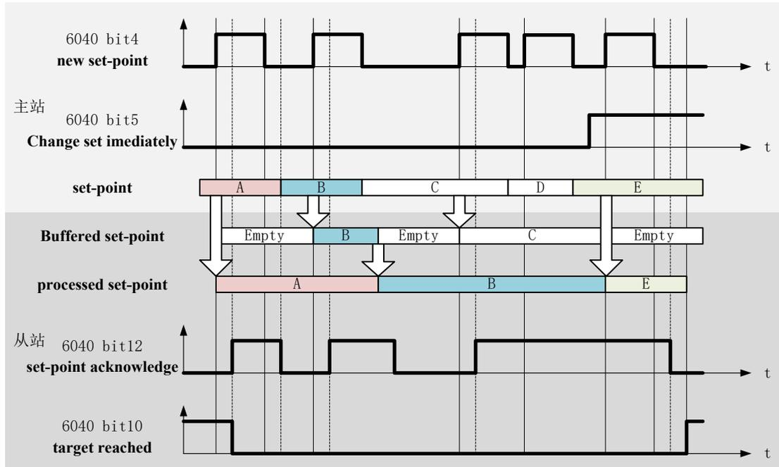
1. 当不处于指令执行状态时, 新的set-point触发, 新的指令更新, 根据新的指令规划运动曲线, 开始执行定位动作。
