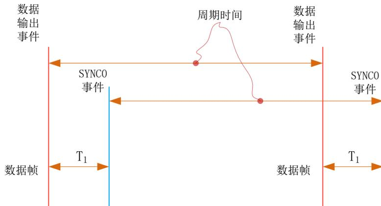
注: AS3 系列总线伺服支持 DC 同步功能, 用户在做控制配置时, 请通过主站开启 DC 功能。主站相关操作可以参考[第十一章](#)例程。
