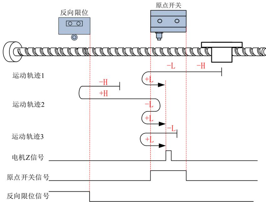
**运动轨迹 1:** 回零启动时减速点信号无效, 未遇到反向限位开关。
