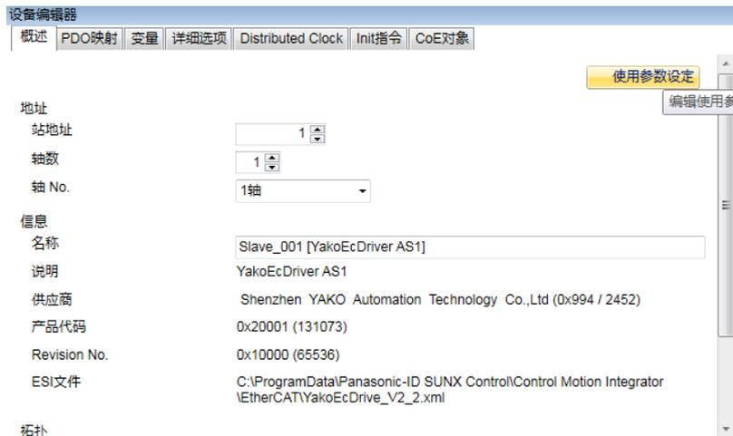
根据驱动器默认的情况下分别用X0(2310h)、X1(2311h)、X2(2312h)定义的“原点”、“正限位”、“负限位”，对应的是“输入端子状态(60FDh)”的bit2、bit1、bit0。若应用并执行回原点功能还需确定驱动器和控制器两者的“输入端子状态(60FDh)”对应关系是否一致。
