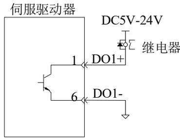
注：当上位机为继电器输入时，请务必接入续流二极管，且方向正确，否则可能损坏 DO 端口。
