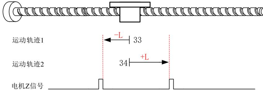
**运动轨迹 1:** 电机以设定较低速度反向运行, 遇到电机 Z 信号时停止运行;
