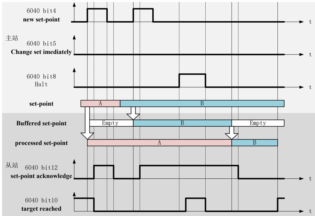
1. PP动作中如果6040h(Controlword)的bit8(halt)是1, 暂时停止定位工作, 更具605D(Haltoptioncode)的选择, 进行减速停机。当bit8(halt)返回0后再次开始执行剩余的定位动作直至完成。
