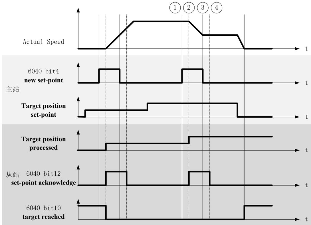
6040h(Control word)的bit5(change set immediately)是1时，如果已将动作中定位动作数据的变更，中断现在的定位动作，立即开始下一定位动作。
