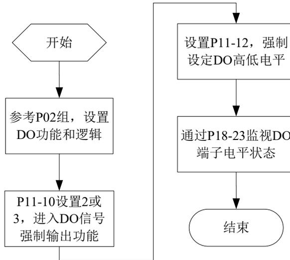
图7-7DO信号强制输出设定步骤示意图
