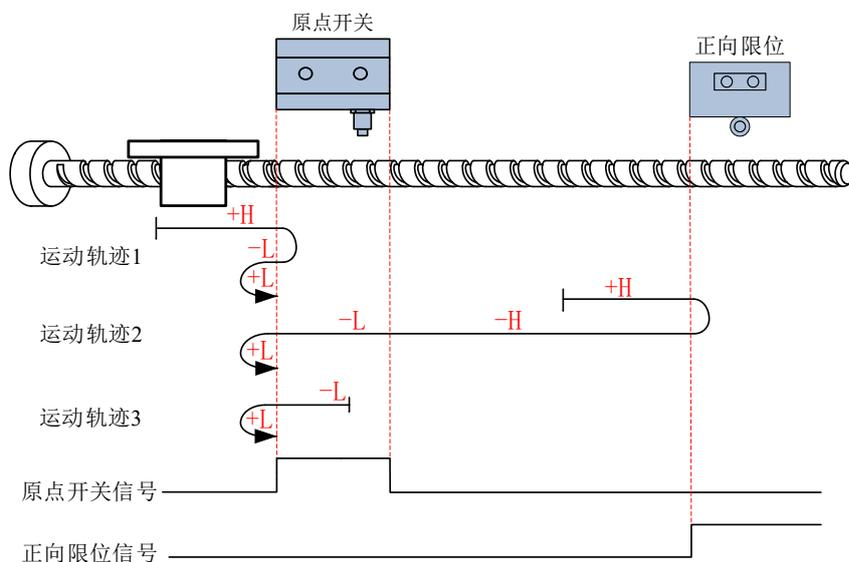
**运动轨迹 1:** 回零启动时减速点信号无效, 未遇到正向限位开关。
