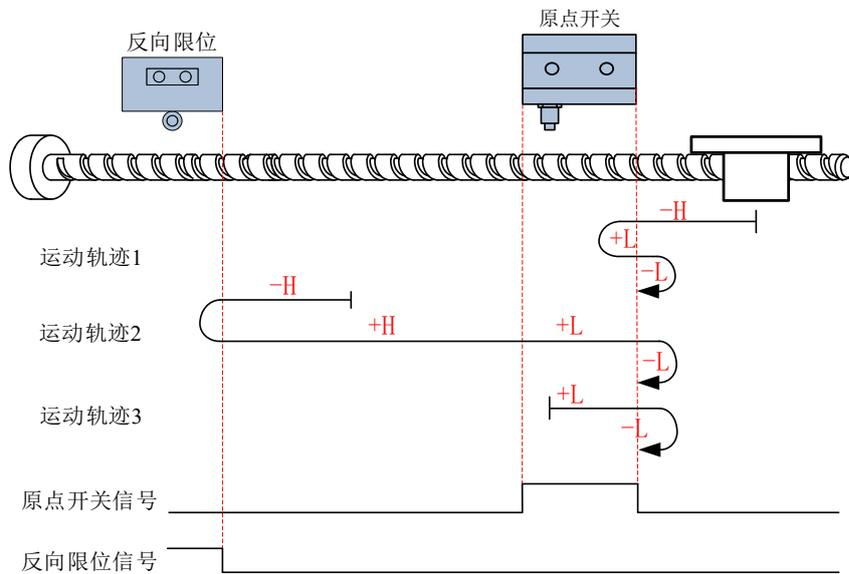
**运动轨迹 1:** 回零启动时减速点信号无效, 未遇到反向限位开关。
