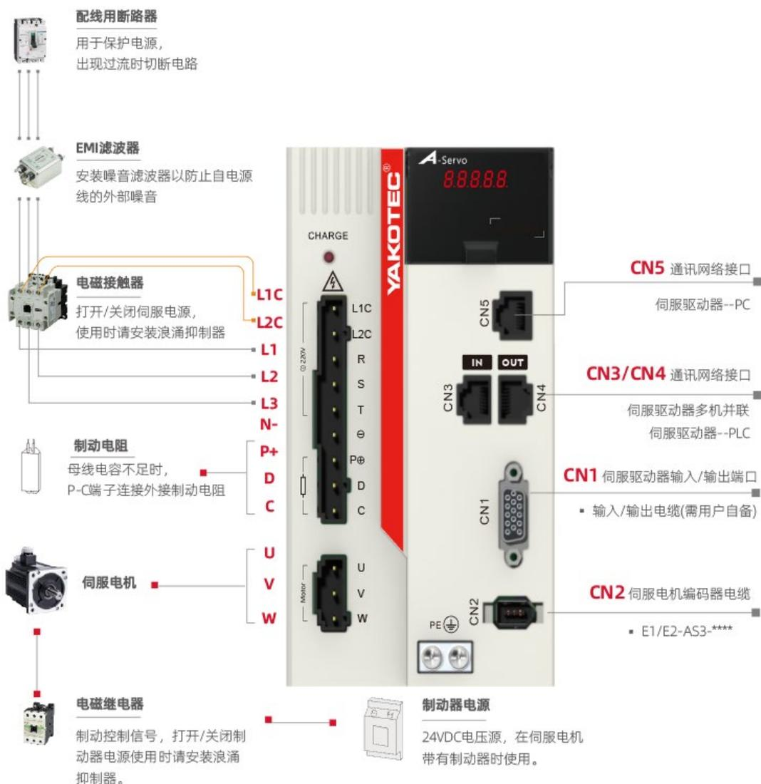
图3-2 1.5~2KW系统结构图
