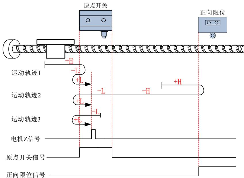
**运动轨迹 1:** 回零启动时减速点信号无效, 未遇到正向限位开关。
