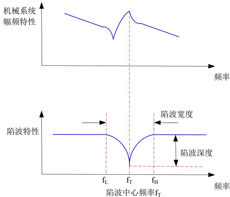
图6-10 陷波器原理
