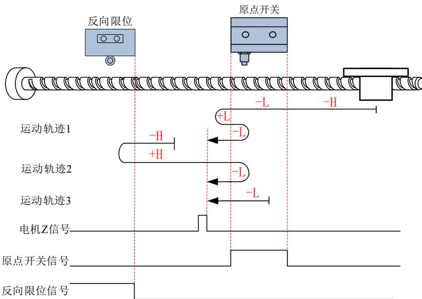
**运动轨迹 1:** 回零启动时减速点信号无效, 未遇到反向限位开关。
