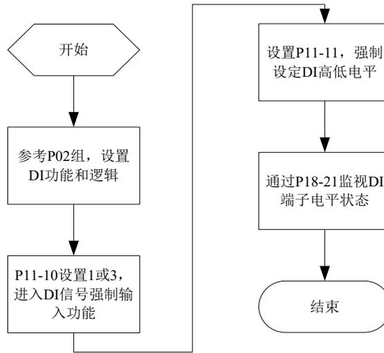
图7-5DI 信号强制输入设定步骤示意图
