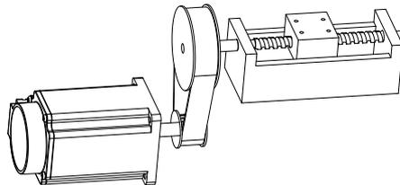
图5-19 滚珠丝杠传动机构示意图
