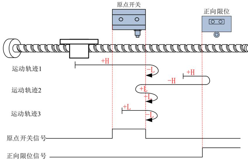
**运动轨迹 1:** 回零启动时减速点信号无效, 未遇到正向限位开关。
