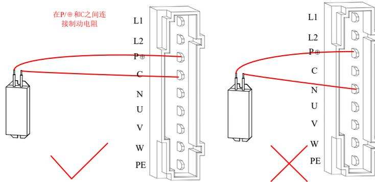
图5-9 AS3-02BNI、AS3-04BNI机型外接制动电阻连接示意图
