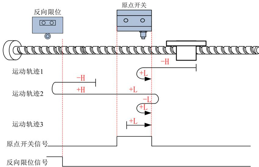
**运动轨迹 1:** 回零启动时减速点信号无效, 未遇到反向限位开关。
