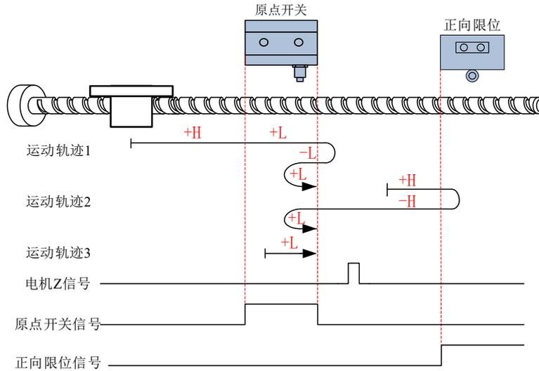
**运动轨迹 1:** 回零启动时减速点信号无效, 未遇到正向限位开关。
