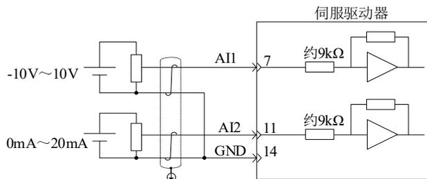
图 3-8 模拟来输入信号接线图
