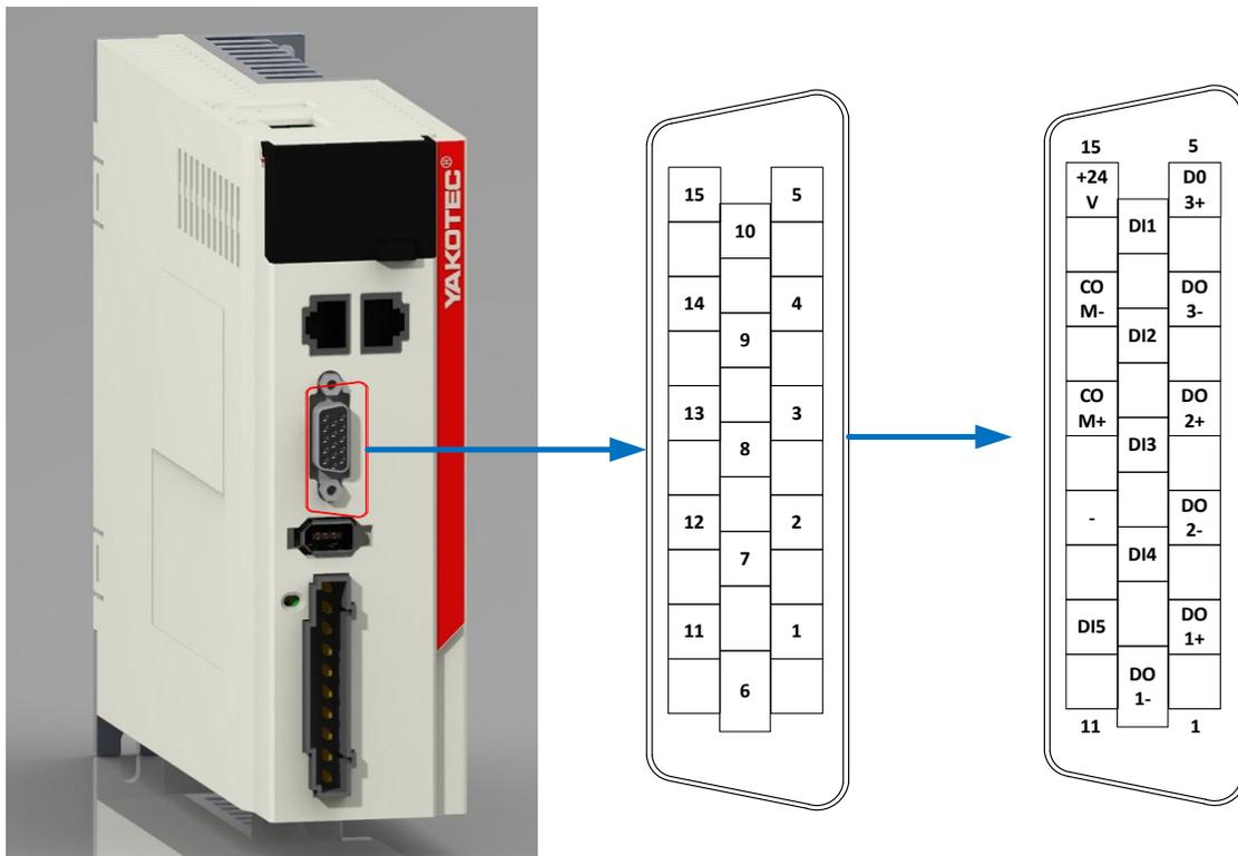
图 3-3 CN1 接口引脚分布图
