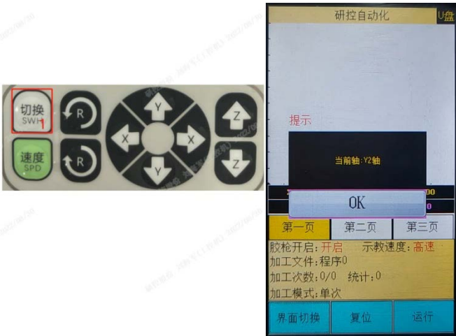
双Y轴坐标显示操作：通过手持编程器中的“切换”按键进行Y1、Y2当前坐标显示切换。
