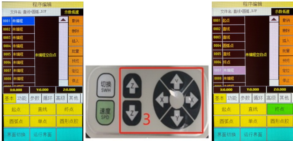
多段直线+圆弧点胶编程
