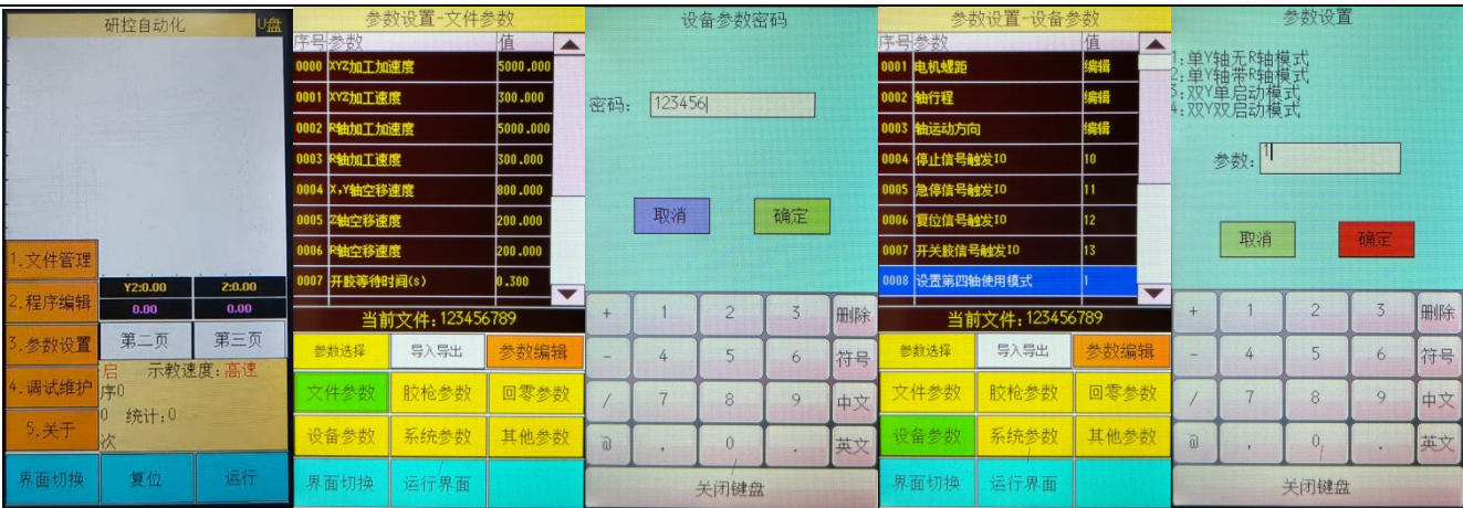
双Y轴坐标显示操作：通过手持编程器中的“切换”按键进行Y1、Y2当前坐标显示切换。
