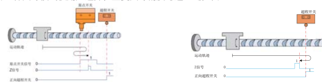
减速点为原点开关,原点为电机Z信号
